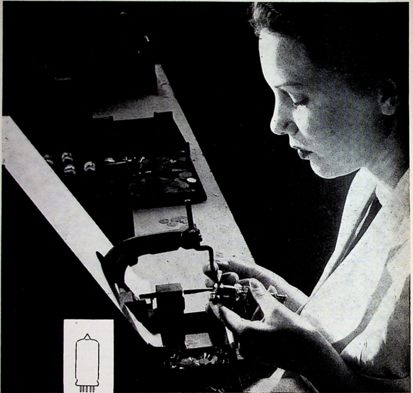
Het puntlassen van een elektrodensysteem.
